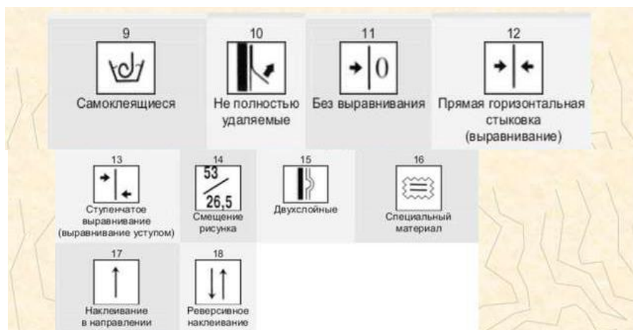
Рисунок 22 Таблица международных символов (маркировка)
