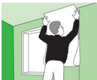
Рисунок 26 Схема прикладывания полотна обоев к стене
